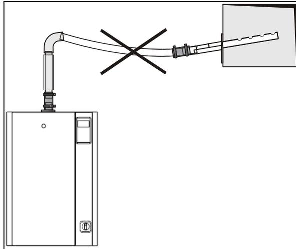
Illustration 34 - Installation erronée de la sortie de vapeur
