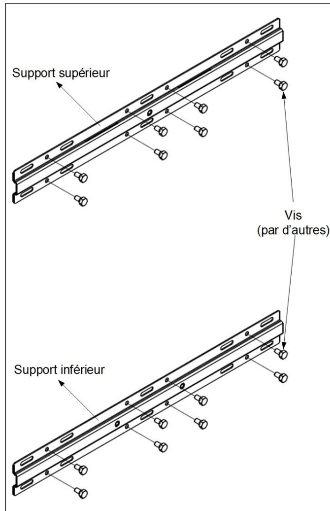
Illustration 10 - Fixation des supports de montage
