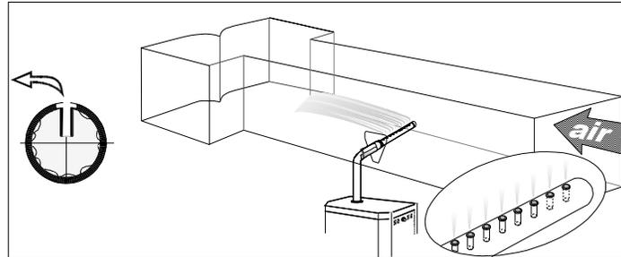
Illustration 23 - Distributeur S.A.M. dans conduit horizontal
