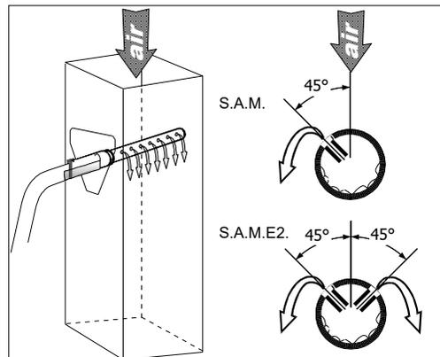
Illustration 25 - Distributeur S.A.M. ou S.A.M.E2 dans conduit vertical
