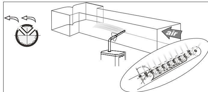
Illustration 24 - Distributeur S.A.M.E2 dans conduit horizontal
