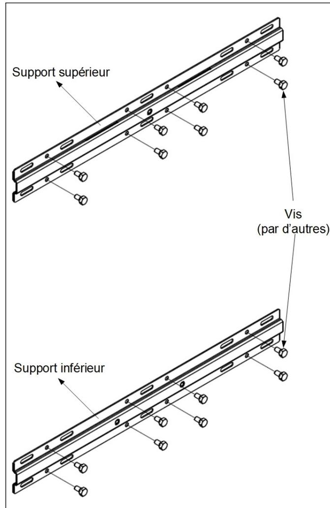
Illustration 14 - Fixation des supports de montage OSHPD
